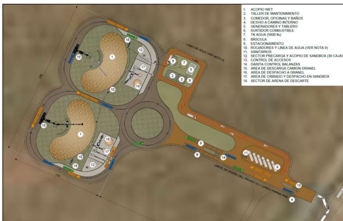
Figura N°5: Sectorización esquemática del predio donde funcionará el HUB de arena de fractura.
