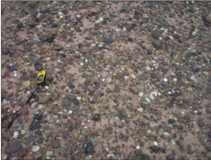
Foto N°8: Depósitos coluviales de hasta tamaño guijas que se observan en las zonas pedimentadas y de bajadas aluviales del área del proyecto. Coordenadas: x: 5845303; y 2486648.
