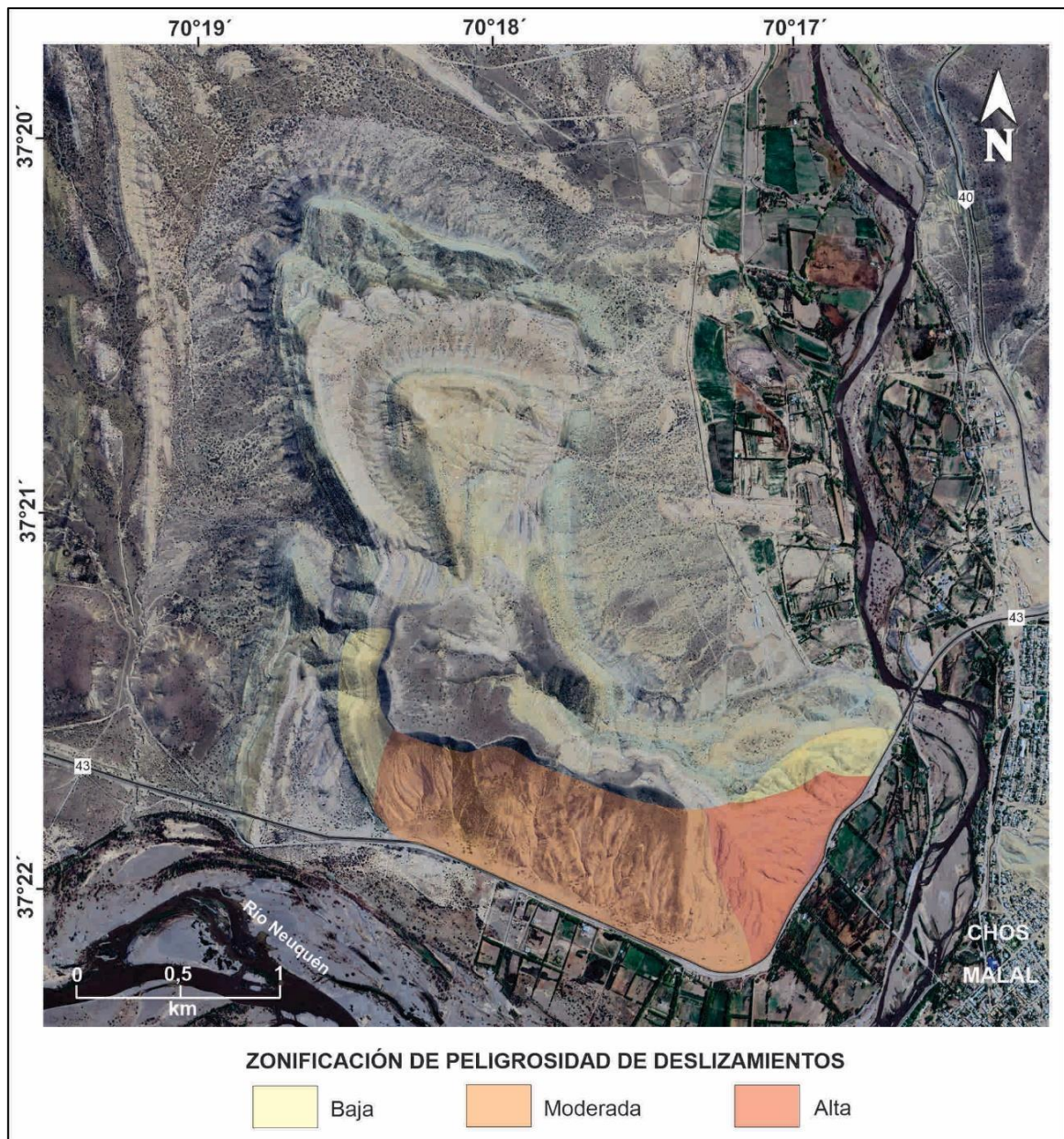
Figura 6. Boceto de zonificación de peligrosidad de deslizamientos para el flanco meridional del cerro de la Virgen. Fuente de la imagen satelital: Google Earth (imagen de fecha 10/07/2022).
