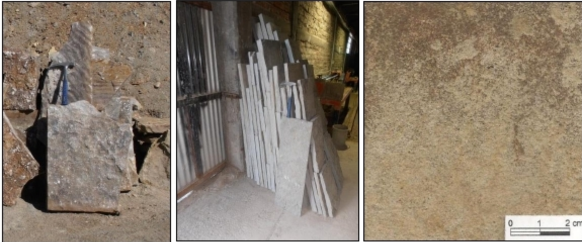
Fig.20a y b: textura de la roca en plano natural y en piezas recuadradas en la planta de corte. Fig.21: muestra escaneada en escala 1:1 (Foto: M. Dalponte).
