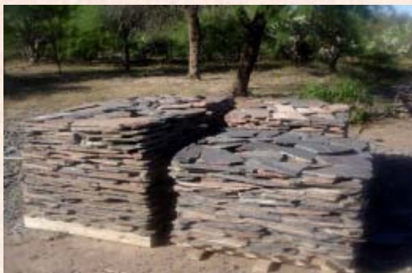
Acopio de lajas finas
