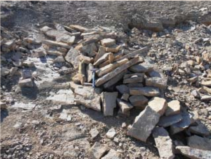
Tamaño y espesor de lajas (0,03 a 0,05 m)
