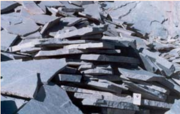
El tamaño y espesor de las lajas es apto para adoquines y baldosas
