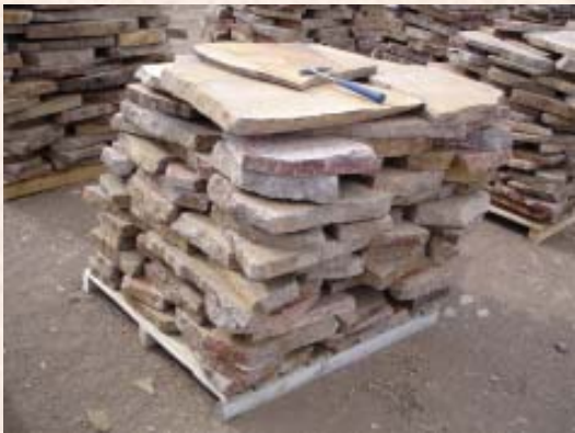
Pallets de lajas "ocres". Planchas de tipo normal con espesores entre 4 y 12 centímetros
