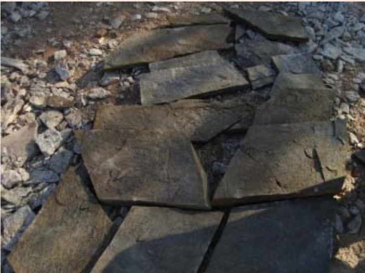
Lajas de forma romboidal limitadas por diaclasas, obtenidas a partir de la apertura manual de bloques de esquistos
