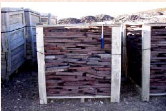
Pallets con lajas Los espesores más comunes son entre 2 y 8 centímetros
