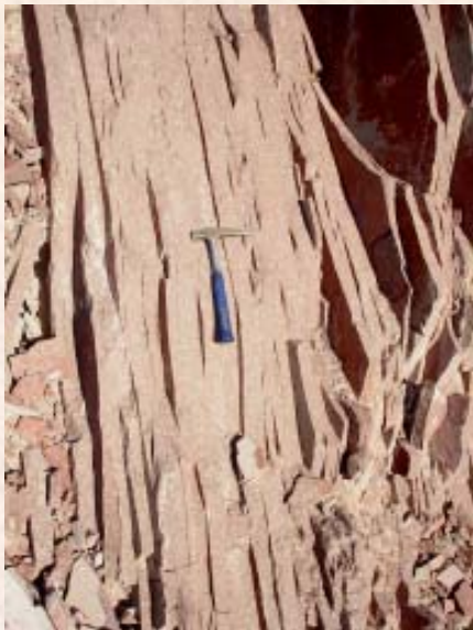
Lajeado de tipo normal en el frente de cantera con espesores desde 2 hasta 10 centímetros
