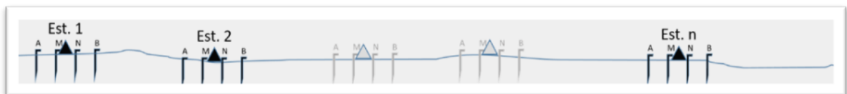
Figura 13: Croquis esquemático del desarrollo de una calicata eléctrica.
