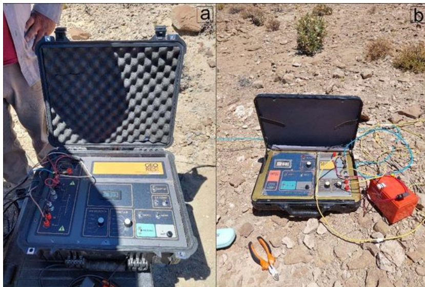
Foto 10: (a) - georesistivímetro digital (GeoRes VM700). (b) - equipo alternativo (Geo Res).
