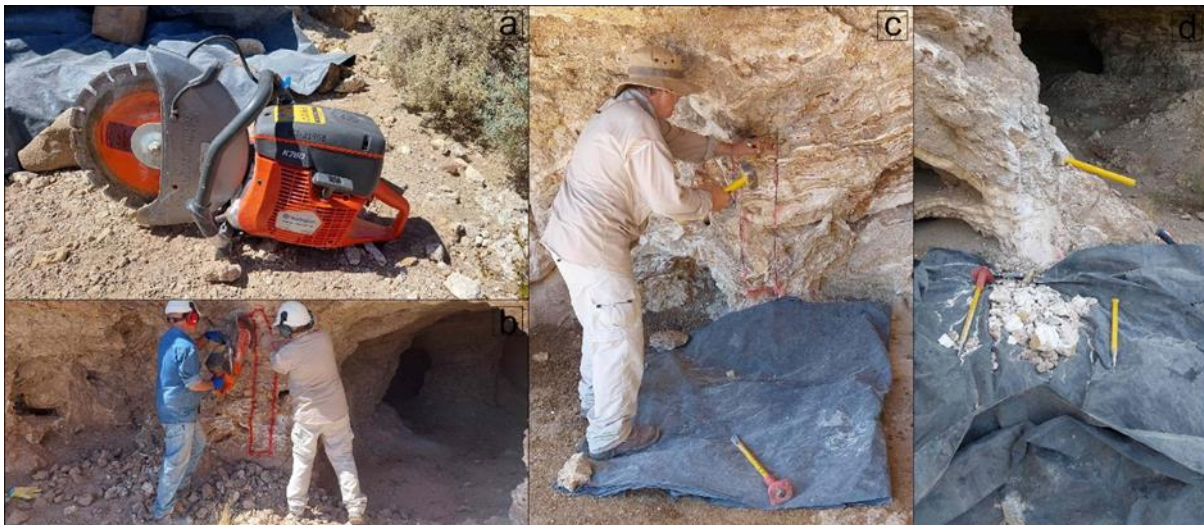
Foto 12: (a) - Cortadora de concreto disco diamantado. (b) - Corte de canaleta. (c) - Muestreo en canaleta. (d) - Herramientas de muestreo.
