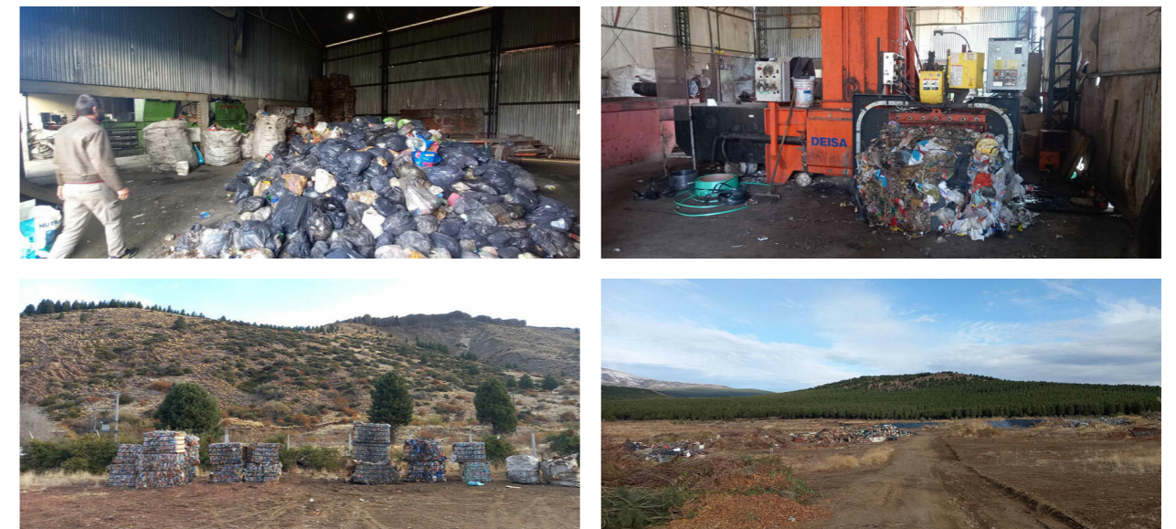
▲ Imagen 18. Compilación de imágenes de sistema de gestión de residuos. Superior izquierda: Interior de la Planta municipal de separación de RSU. Superior derecha: La máquina enfardadora (rechazos). Inferior izquierda: Residuos reciclables enfardados a la espera de su traslado. Inferior derecha: Ingreso al Centro de disposición final. Fuente: ONU-Habitat, 2023.
